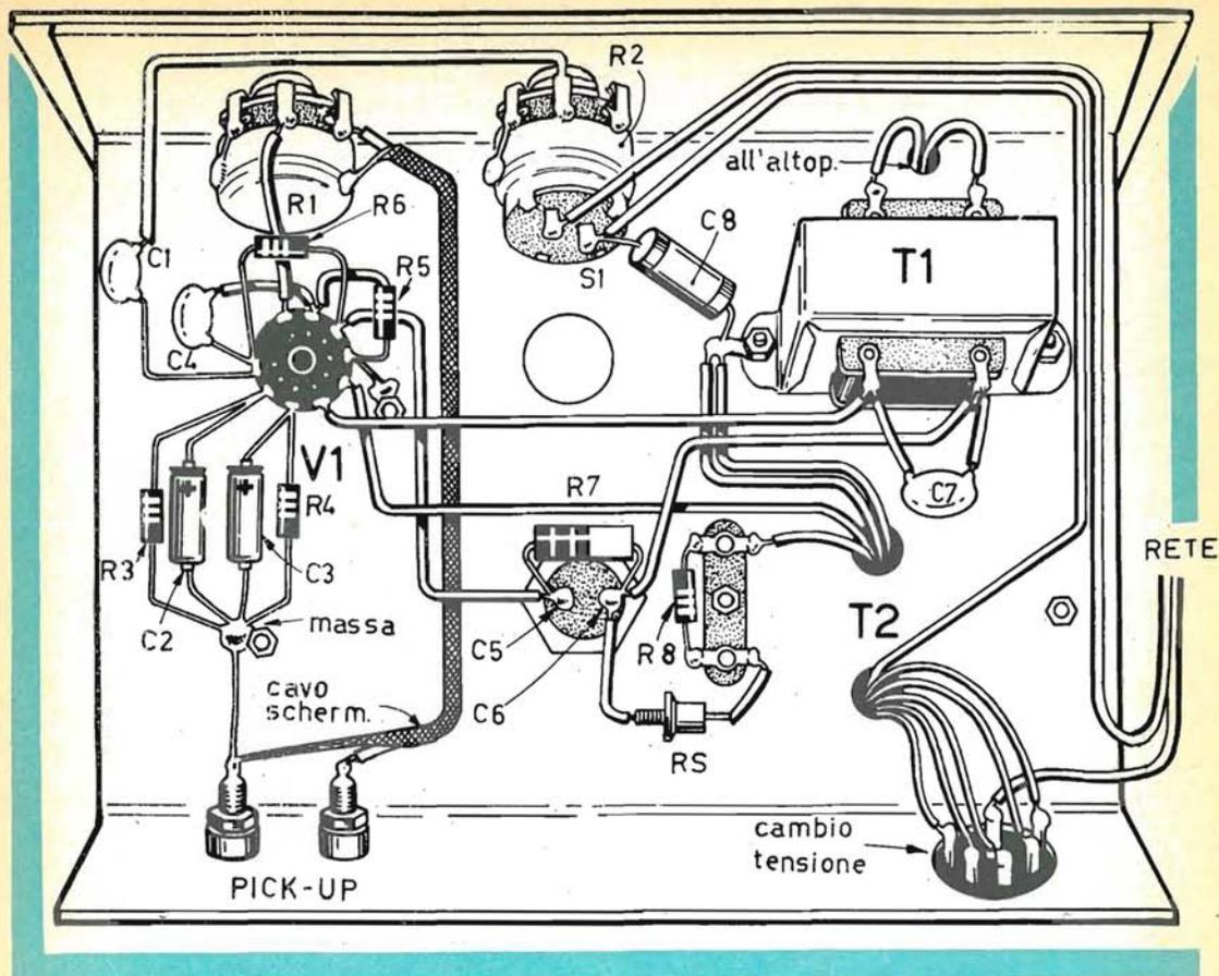
come si sa, è uno strumento che correda il laboratorio del radiotecnico e si rende oltremodo utile nelle riparazioni dei ricevitori radio e degli amplificatori con circuiti a valvole e a transistori, perchè permette di segnalare la presenza o di denunciare l'assenza di segnale in ogni punto del circuito in riparazione.
