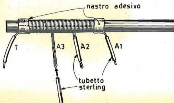
Le tre prese intermedie ricavate nella bobina di sintonia L1 permettono di scegliere l'innesto più adatto per il miglior accordo di antenna.
