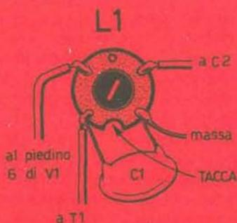
Il disegno riproduce, in pianta, lo schema della bobina di sintonia di tipo Corbetta CS 3/BE. La numerazione dei terminali è fatta in senso orario (secondo il movimento delle lancette dell'orologio) a partire dalla tacca.
