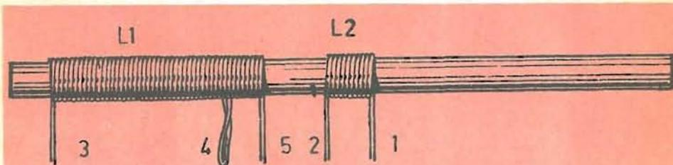
Le bobine L1 ed L2 devono essere avvolte su uno stesso nucleo ferrocube di forma cilindrica e delle dimensioni di 8 x 140 mm. L'avvolgimento L1 ha inizio ad 1 centimetro circa da una delle estremità del nucleo. La distanza della bobina L2 da quella L1 va determinata sperimentalmente in sede di messa a punto del ricevitore.
