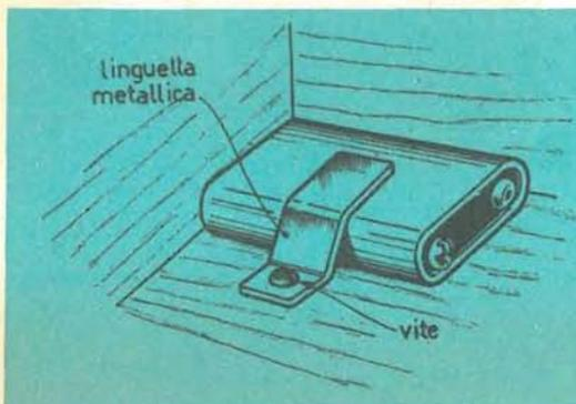
La pila di alimentazione da 9 volt rappresenta un componente che deve poter essere facilmente rimosso dal circuito per eseguirne il ricambio. Il sistema di ancoraggio illustrato in figura è molto semplice e razionale: si tratta di applicare alla cassetta una lamella di acciaio, mantenuta bloccata da una vite da legno.
