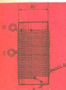
La bobina di sintonia L 1 è un componente che va costruito con la massima attenzione. Le prese intermedie C e D vanno ricavate a WX in forma di occhielli, in modo da permettere una comoda commutazione del ricevitore dall'ascolto in onde corte a quello in onde cortissime.
