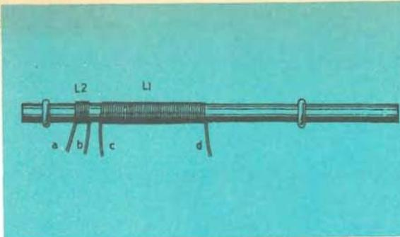
I terminali «c» e «d» della bobina L 1 vanno collegati, rispettivamente, con il conduttore della tensione positiva e con il terminale del condensatore variabile corrispondente al pacchetto di lamelle fisse; i terminali «a» e «b» vanno connessi, rispettivamente, con il circuito di rivelazione e con la base del transistor TR 1.
