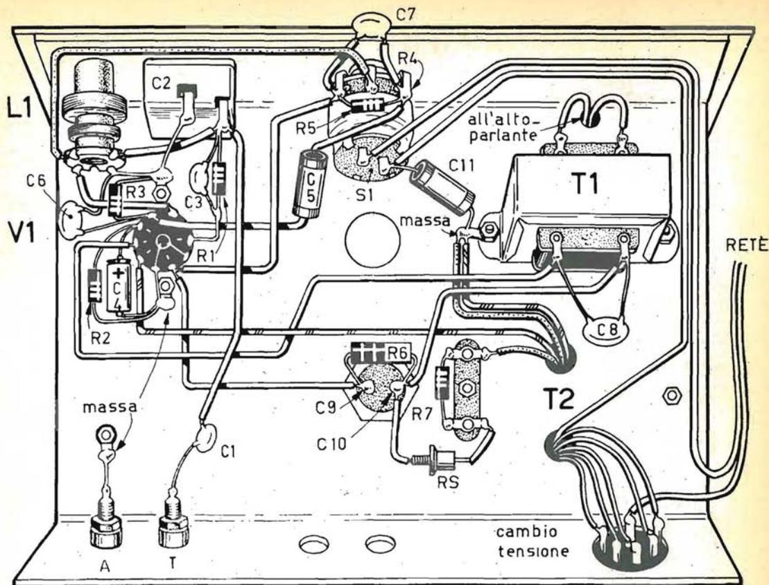
i segnali di bassa frequenza, che vengono applicati, tramite il condensatore C5, alla griglia controllo della sezione pentodo di V1. In questa sezione della valvola i segnali di bassa frequenza vengono amplificati al punto di poter pilotare l'alto-parlante. L'avvolgimento primario del trasformatore d'uscita T1 rappresenta il carico anodico della sezione pentodo di V1.
