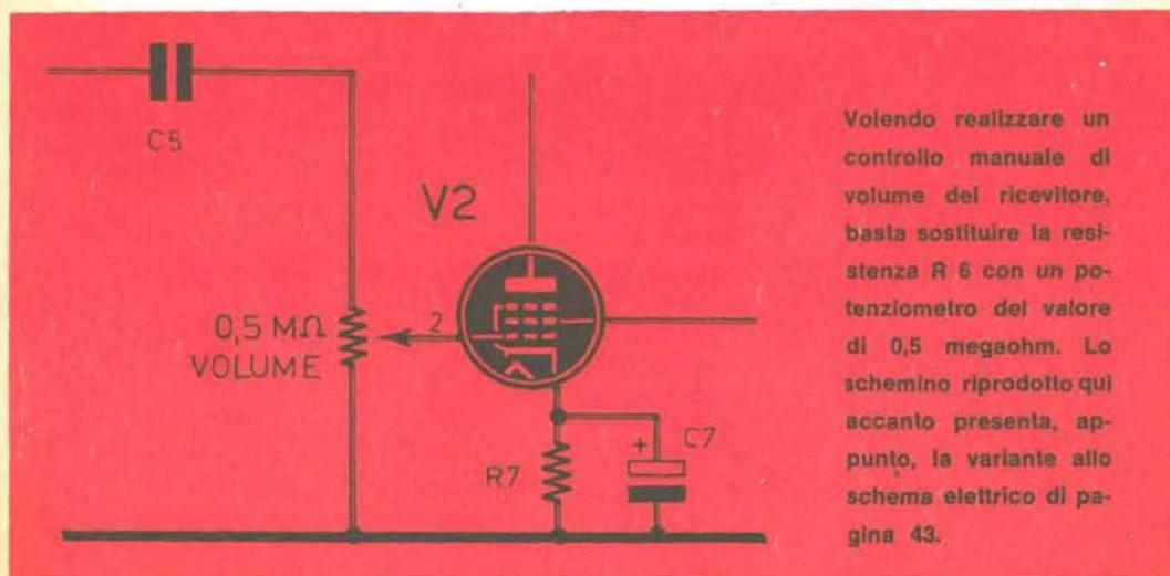
Volendo realizzare un controllo manuale di volume del ricevitore, basta sostituire la resistenza R6 con un potenziometro del valore di 0,5 megaohm. Lo schema riprodotto qui accanto presenta, appunto, la variante allo schema elettrico di pagina 43.
