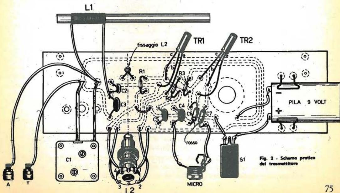
Fig. 2 - Schema pratico del trasmettitore
