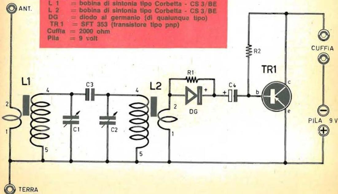
quenza. I segnali di bassa frequenza vengono applicati, tramite il condensatore elettrolitico C4, alla base (b) del transistor TR1. Alla resistenza R1 è affidato il compito di evitare che il diodo si polarizzi attraverso C4. I segnali amplificati sono presenti sul collettore (c) e pilotano la cuffia che, oltre a rappresentare il trasduttore acustico, costituisce pure il carico di collettore del transistor TR1. L'alimentazione del circuito è ottenuta per mezzo di una pila da 9 volt.
