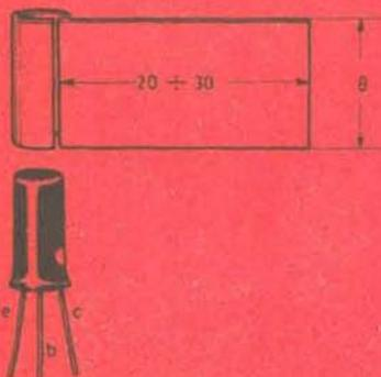
Durante il funzionamento di questo ricevitore, il transistore TR3, che è di tipo SFT 323, si riscalda ed occorre provvedere al suo raffreddamento, mediante una aletta ricavata da lamierino di ferro le cui dimensioni, espresse in millimetri, sono riportate nel disegno.
