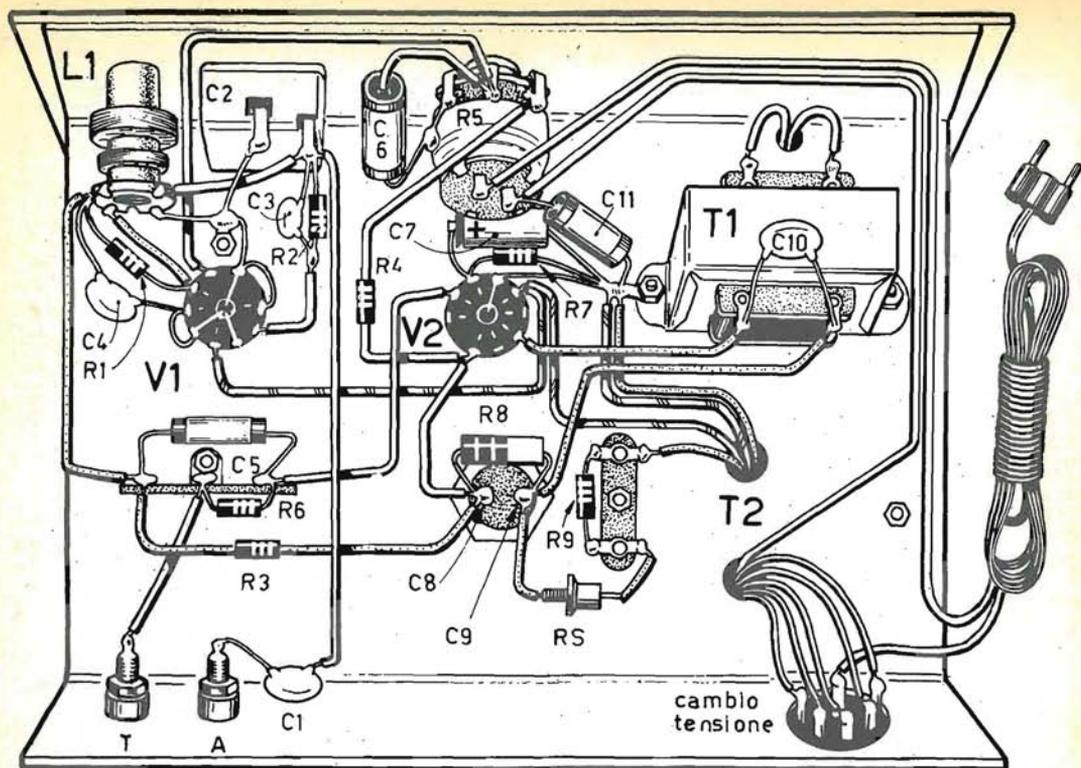
gnali di bassa frequenza vengono applicati, tramite il condensatore C 5, alla griglia controllo (piedino 2) della valvola V 2. In parallelo della bobina di reazione vi è una resistenza (R 1) alla quale compete la funzione di semplificare l'innesco della reazione.
