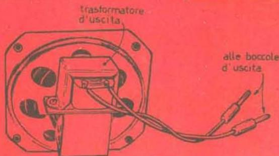
In pratica il trasformatore d'uscita va applicato direttamente sul cestello dell'altoparlante, servendosi di una sbarretta di ferro, di due viti e due dadi.
