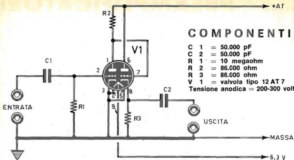
buon livello sonoro nell'amplificatore pur mantenendo basso il controllo di volume e senza incorrere nella distorsione. Il circuito del preamplificatore è pilotato da un doppio triodo (V1). Le due sezioni triodiche sono direttamente collegate fra di loro, cioè l'anodo del primo triodo è direttamente collegato con la griglia controllo del secondo triodo.
