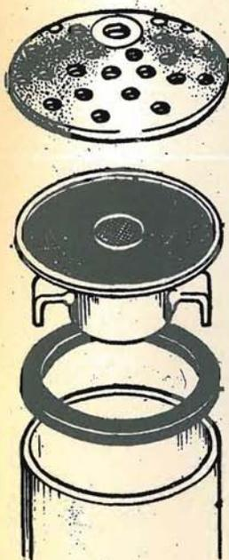
Ecco nel disegno esploso come viene montato l'altoparlante (con funzione di microfono) nella parte superiore del contenitore di plastica. Le due squadrette metalliche applicate all'altoparlante, nelle quali verranno inserite due viti maschianti, servono per fissare il tutto al cilindro di plastica. La griglia a difesa dell'altoparlante si applica con un buon collante.
